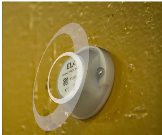
Cette solution permet de **localiser le car-à-fourches** dans l'entrepôt et d'historiser ses déplacements. Les tags permettent de connaître le point de départ et le point d'arrivée de l'équipement logistique et ainsi de calculer le temps de déplacement de ce dernier. Cela permet **d'optimiser et d'automatiser les inventaires**.
