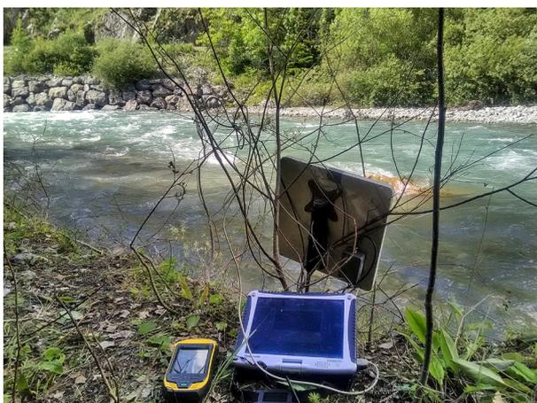
Station fixe de détection des tags (antenne + lecteur RFID)
