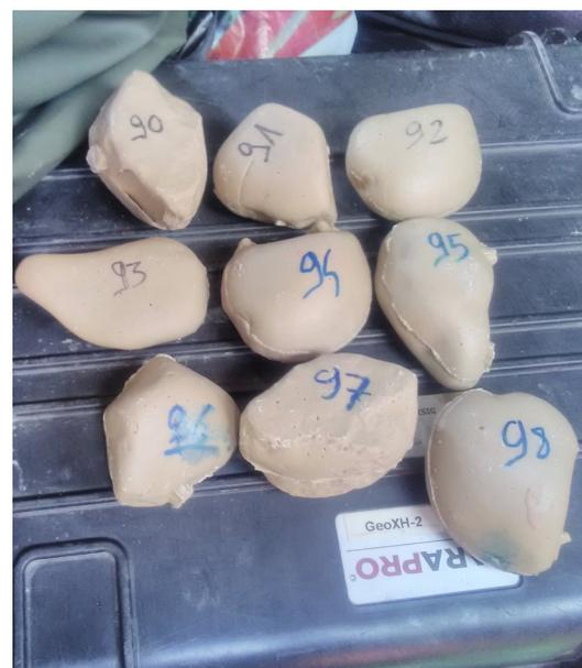
Galets artificiels embarquant des tags RFID Actifs
