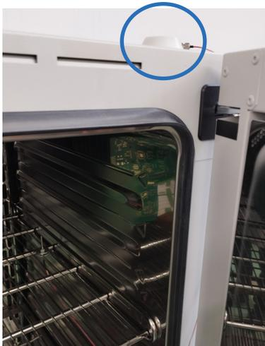
Le boîtier/gateway d'Ercogener collecte les données de ces capteurs via Bluetooth et les transmet à une plateforme cloud via des réseaux cellulaires 4G, garantissant ainsi une mise à jour en temps réel, avec une historisation des données. Le système peut déclencher des alertes dès qu'un paramètre environnemental dépasse les seuils prédéfinis.
